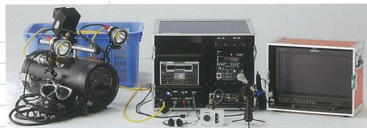
フルハイビジョンカメラ:放送局仕様 (池上通信機HDL45A) 光ケーブル伝送:600m
