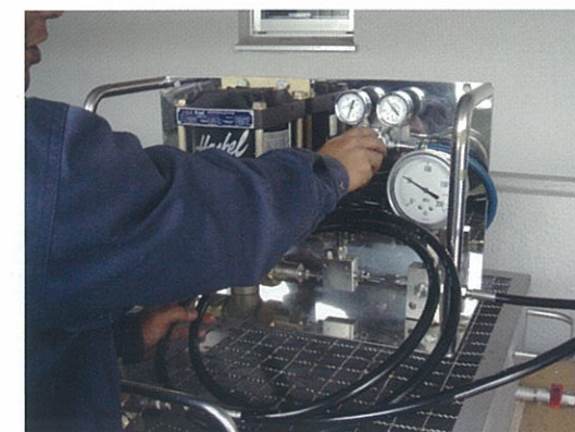
加圧検査状況
