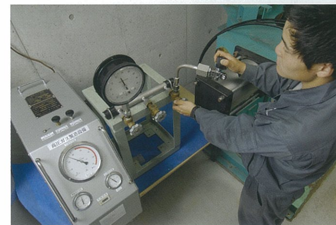
高圧ガス容器バルブ耐圧検査
