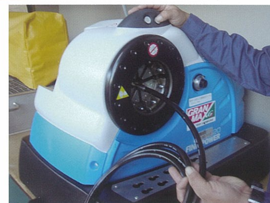
高圧ホース加締め状況
