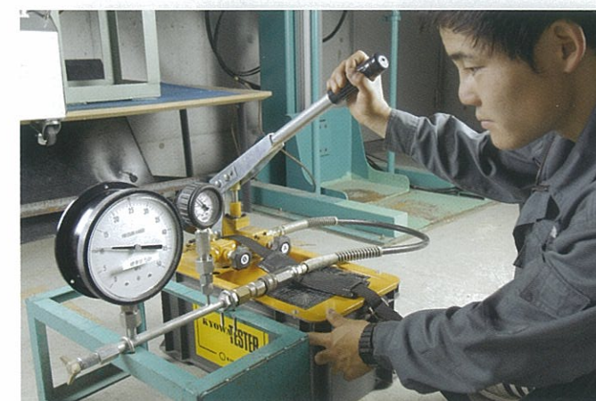
圧力計比較検査
