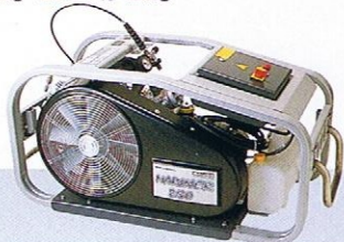
●マリーナ320〈充填〉7分 (12ℓ・200気圧) エアータン容量:460.8ℓ/日 サイズ:L130×W64.5×H70cm モーター付:154kg エンジン付:138kg
