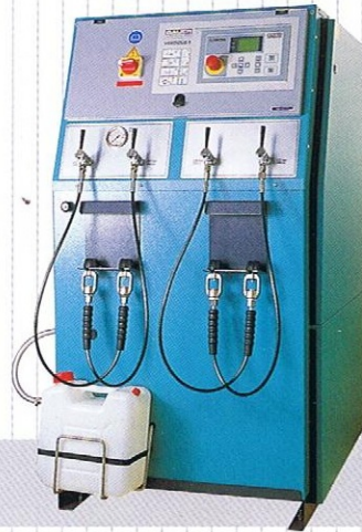
●MV-120 (マリーナ防音タイプ) 〈充填〉12分(12ℓ・200気圧) エアータン容量:288 ℓ/日 サイズ:L100×W70×H128cm 255kg
